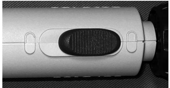
図3 「錠の絵」のみで示された作動の確認がわかりにくい本体(delivery tool)のロック機構 左側が錠が開いている絵でロックが解除されていることを示す。ロックをスライドさせると下から違う色が現れるなどの工夫が必要か。
